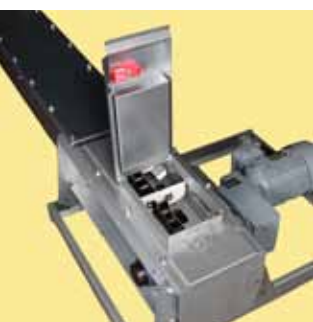
Датчик подпора/смотровая крышка с аварийным выключателем.
